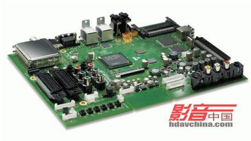
图 NXP(恩智浦半导体)支持 H. 264/MPEG4/MPEG2 的单芯片(PNX8543x)液晶电视方案 TV543, 让用户可直接在 LCD TV 上收看互联网上丰富的基于 H. 264/MPEG4 的 SD 和 HD 内容。PNX8543x 还集成了 2 个 HDMI V. 1. 3 端口, 支持 MPEG1、AAC V2 或者 AC-3。
